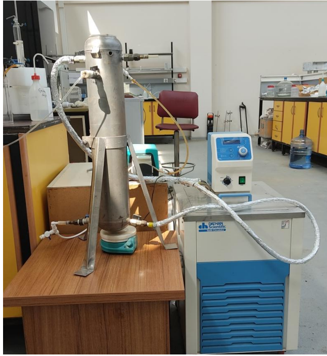
Şekil 3. 4. UV reaktör fotoğrafı
