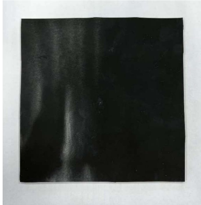
Şekil 3.3. Basınç kalıplama ile vulkanize edilmiş FKM plaka
