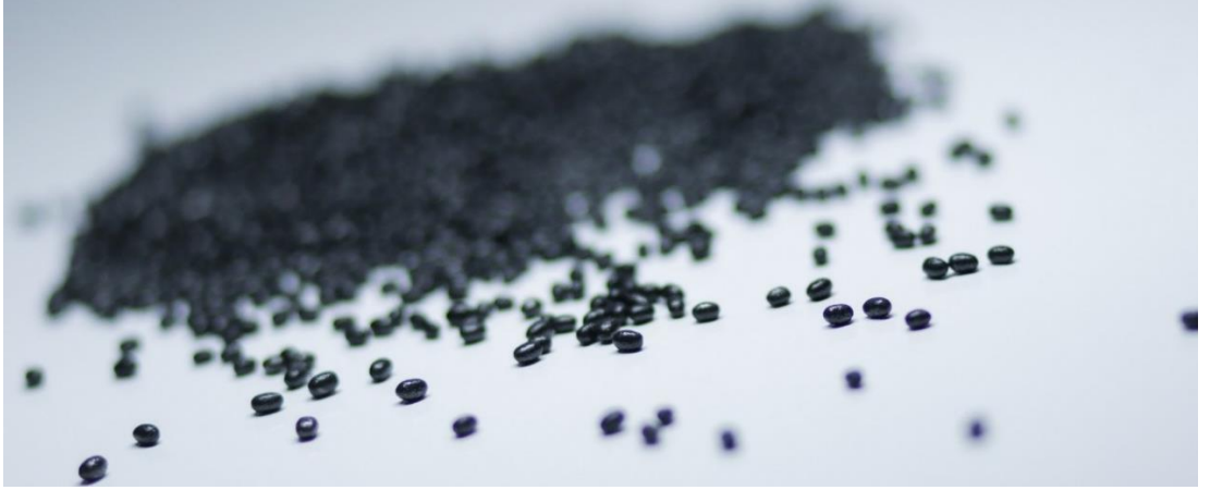
Şekil 2.1. EPP Köpük Malzeme Yapısı ( www.polmar.com.tr/epp.php 2021)
