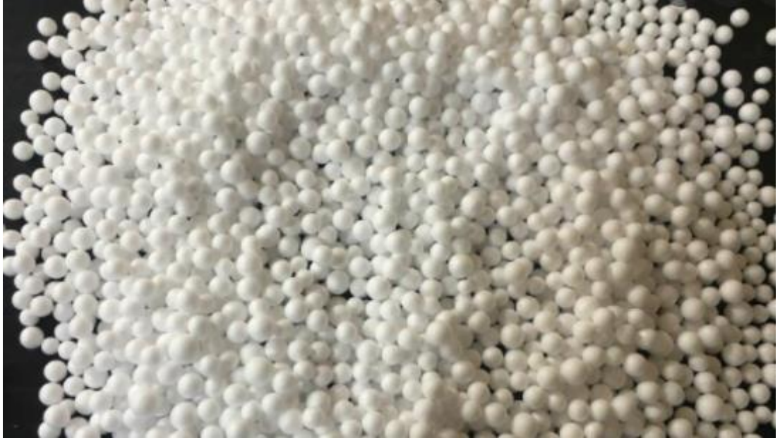
Şekil 2.2. EPS Köpük Malzeme Yapısı ( www.malzemebilimi.net/strafon-nedir-nasil-uretilir-eps-ile-farki-nedir.html 2021)
