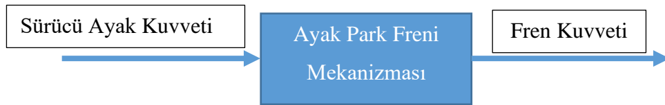
Şekil 1.1. Ayak park freni mekanizması fonksiyon diyagramı
