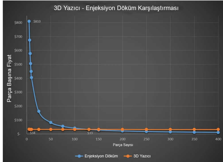
Şekil 3.4. 3B yazıcı ve enjeksiyon döküm karşılaştırılması ( https://imalusulleri.com/3d-yazicilarin-avantajlari-ve-dezavantajlari/ )(Erişim tarihi: 01.04.2022)
