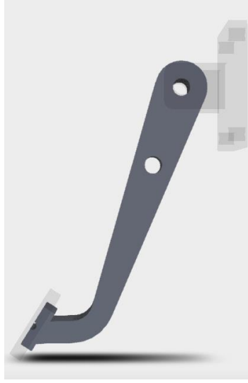
Şekil 3.7. Topoloji optimizasyon çalışması yapılacak pedal
