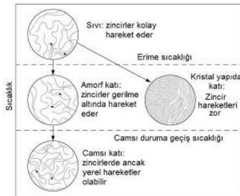
Şekil 2.4. Sıcaklığın yapı ve özelliklere etkisi (Aran 2008)
