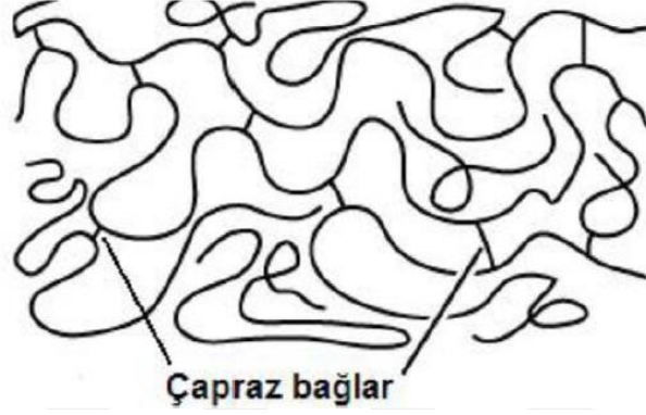
Şekil 2.6. Termoset bağ yapısı (Aran 2008)
