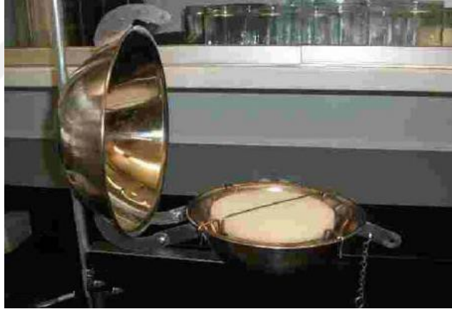
Şekil 4.6. Dış ortam pasif hava örnekleycisi
