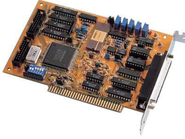
Şekil 3.9. Advantech PCL-818 arabirim kartı
