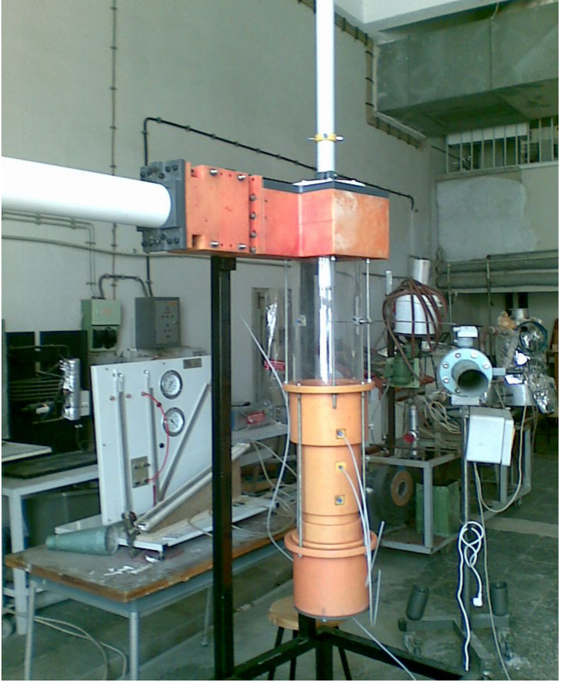
Şekil 3.6. Deneysel çalışmada kullanılan özel olarak tasarlanmış siklon
