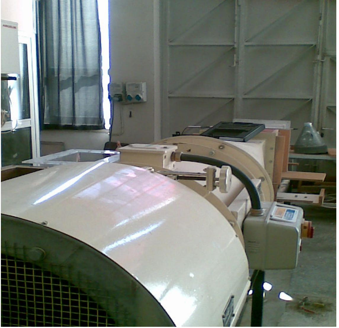
Şekil 3.7. Pitot tüpünün kalibrasyonu için kullanılan rüzgar tüneli
