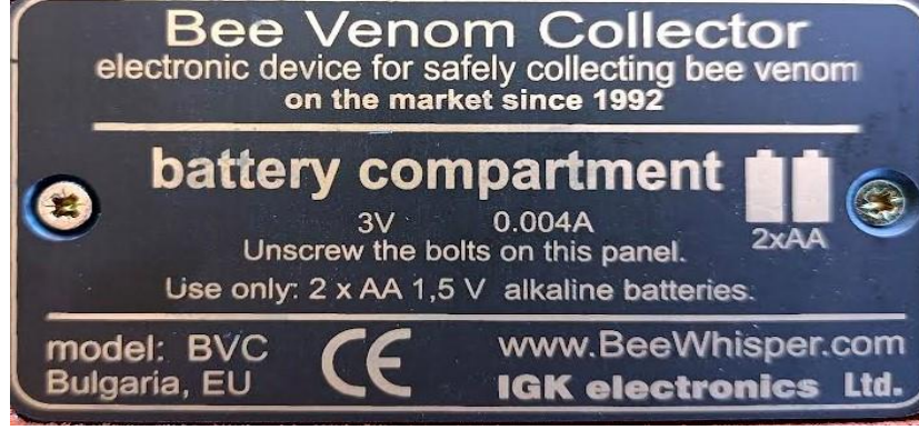
Şekil 7. Bee whisper kovan özü zehir toplama cihazının elektrik teknik özellikleri.
