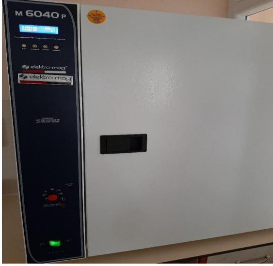
Resim 8: Rutubet analizi için kullanılan etüv.
