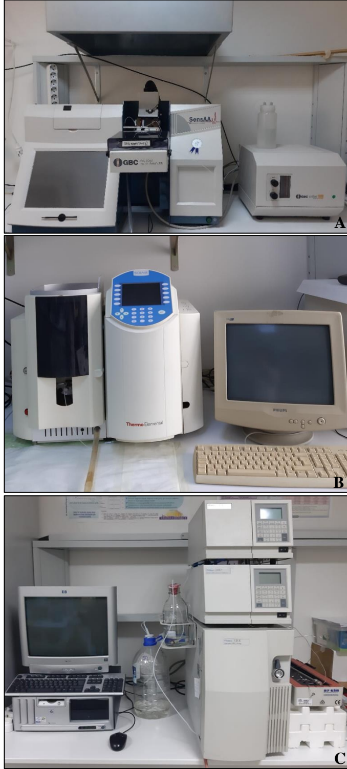
Şekil 3.1. Çalışmada kullanılan A. Elektrotermal atomik absorpsiyon spektrofotometresi (ET AAS), B. Alevli atomik absorpsiyon spektrofotometresi (A AAS) C. Boyut eleme kromatografisi (SEC) cihazı
