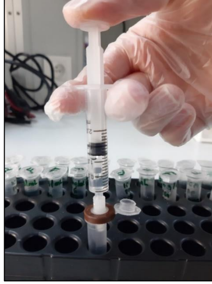
Şekil 3.2. Standart polimer çözeltilerinin şırınga ucu filtre ile süzülmesi
