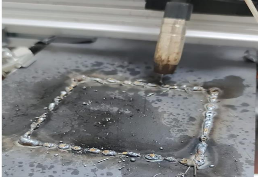
Şekil 4.9 İlk deneme sonrası kaynak makinesi tel sürme hızının yetersiz kalması sonucu oluşan ilk kaynak dikişi.
