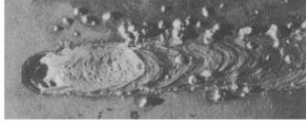
Şekil 3.28 Kaynak dikişinde sıçranta görseli (Weman, Linden, 2006)
