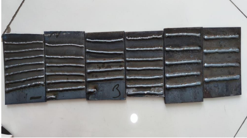
Şekil 3.29 Soldan sağa akımın ve tel sürme hızının arttırılmış haldeki kaynak dikişi denemeleri
