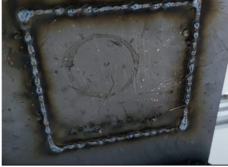
Şekil 4.10 İkinci deneme sonucunda elde edilen daha düzenli kaynak dikişini
