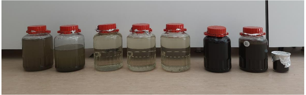
Şekil 3.5. Tesisin farklı ünitelerinden alınan atıksu ve çamur numuneleri
