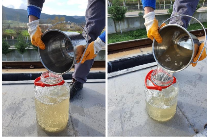
Şekil 3.8. Anlık olarak toplanan atıksu numuneleri
