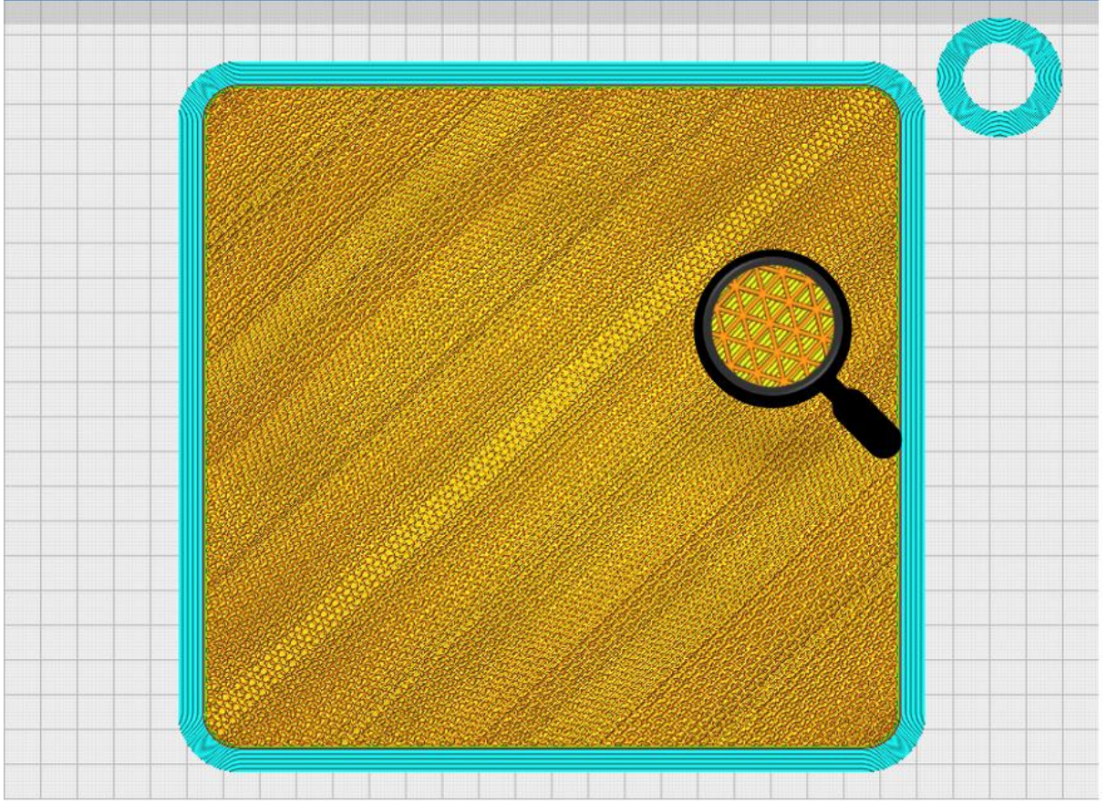
Şekil 3.14. %60 dolulukta üçgen iç yapılı plaka basım şekli
