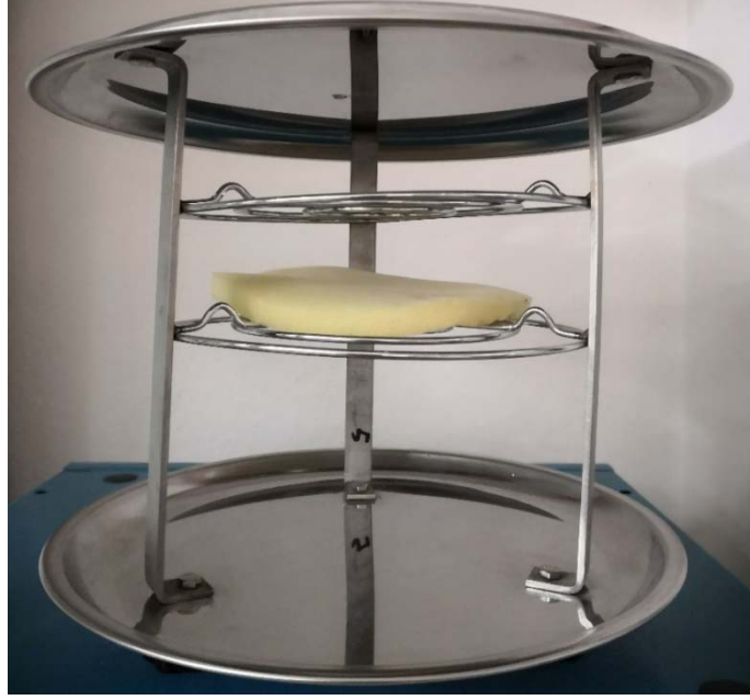
Şekil 2.3. İç ortam pasif hava örnekleyicisi ve poliüretan köpük (PÜK) disk
