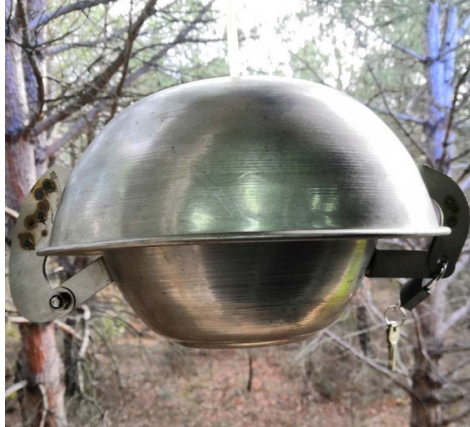
Şekil 2.4. Dış ortam pasif hava örnekleyicisi
