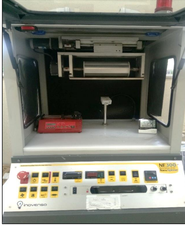
Şekil 3.4. Nanolifli yüzeylerin üretiminin gerçekleştiği elektro çekim ünitesi
