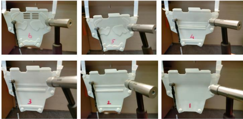
Şekil 3.11. Numunelerin deney sırasında mesnetlenmesi ve ivme ölçerin konumlandırılması
