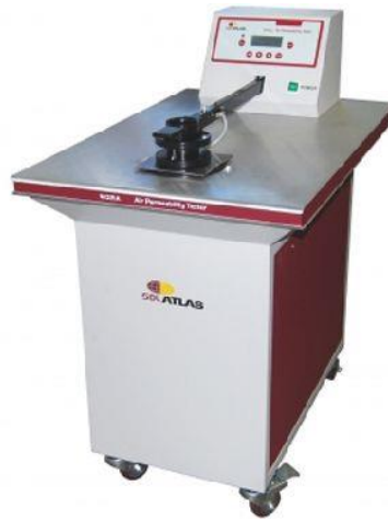
Şekil 3.2. SDL ATLAS MO21A hava geçirgenlik test cihazı
