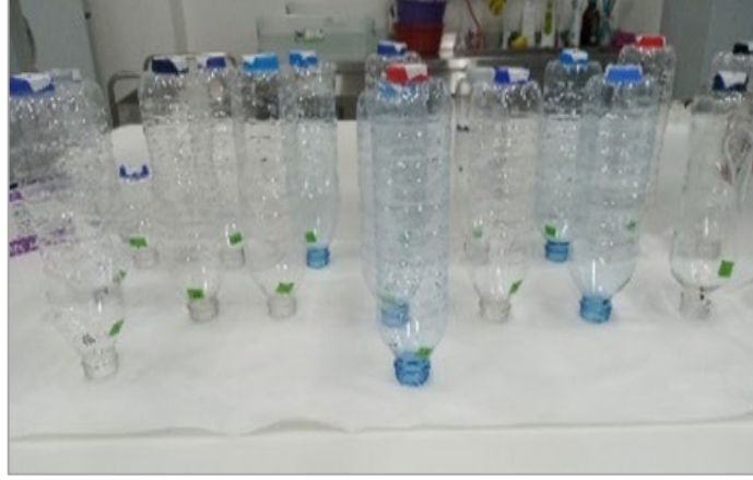
Şekil 3.5. PET şişelerin özütlenme işlemi
