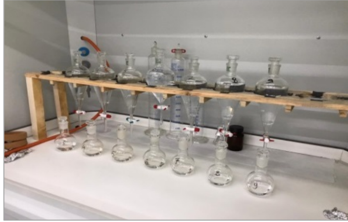
Şekil 3.4. Ambalajlı suların özütleme işlemi
