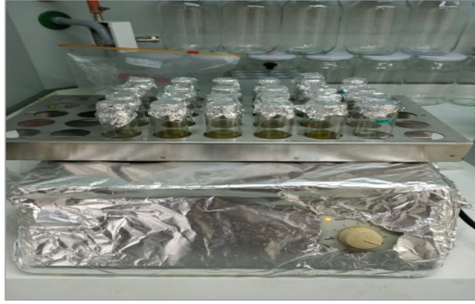
Şekil 3.6. Tereyağı örneklerinin özütlenme işlemi
