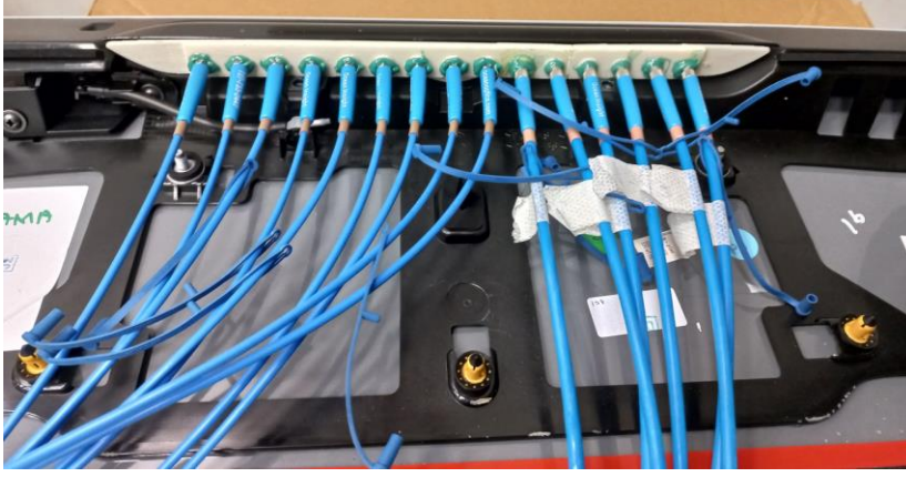
Şekil 3.29. FOCAS'ın hava deflektörüne montajından sonra arkadan görüntüsü
