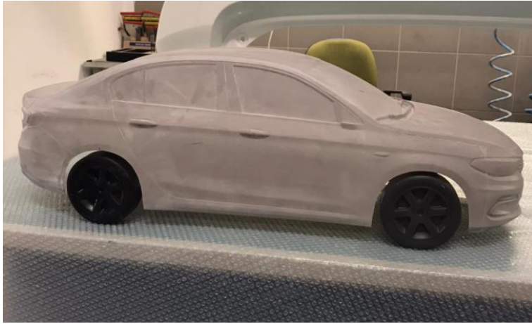
Şekil 3.3. 1/5 oranlarında küçültülmüş bir araç prototipi
