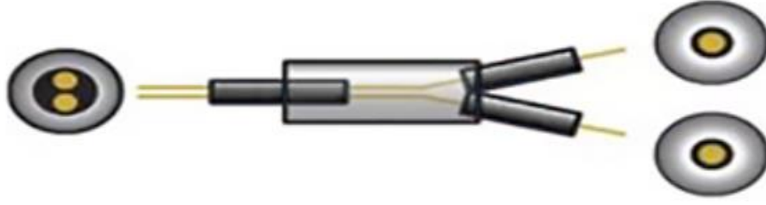
Şekil 3.8. 1×2 bölünmüş fiber optik kablo kesit görüntüsü
