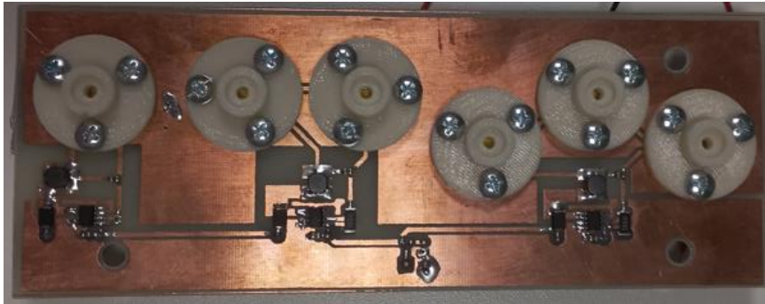
Şekil 3.12. FOCAS CHMSL PCB prototipi- LED’ler üzerinde kuplaj ile
