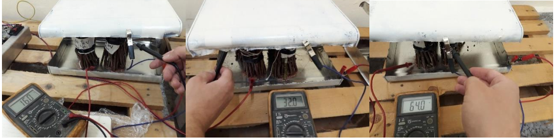
Şekil 3.6. Levhalar arasına yerleştirilen çeliklere 16-32-64 Volt uygulaması
