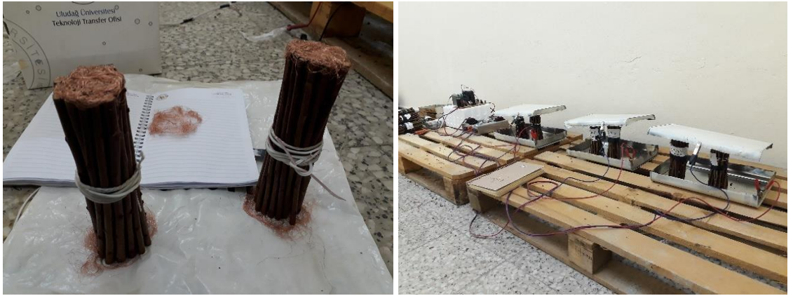
Şekil 3.7. Elektrik uygulamasında çeliklerin üzerine bakır tel ağı yerleştirilmesi
