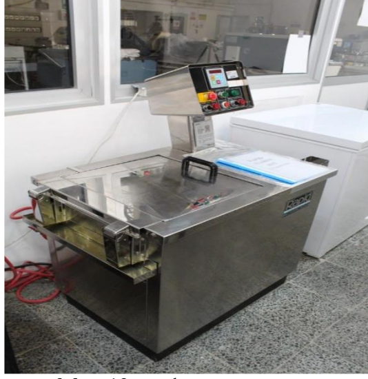
Şekil 3.1. Rapid Xiamen Model H-12 yağ banyosu
