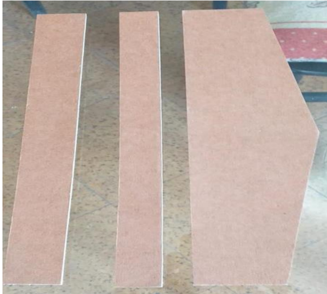
Şekil 10. Şiraze, dudak payı ve miklep bölümleri ayrı olarak kesildikten sonra tasarıma uygun olarak deriye yapıştırılır.
