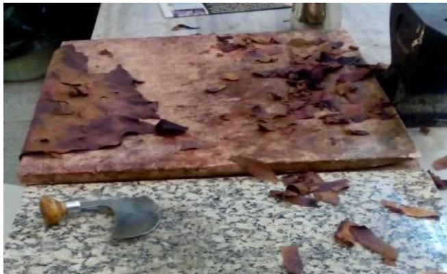
Şekil 8. Derinin tıraşlanması, istenilen boyutta ve renkte deriyi belirledikten sonra tıraşlama işlemine geçilir.
