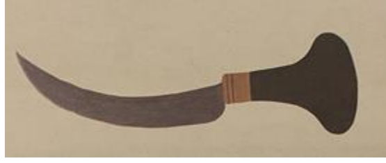
Şekil 5. Oymacılıkta eskiden kullanılan keski aleti "Nevregen".
