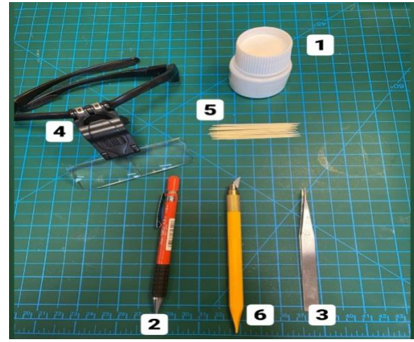
Şekil 15. Kullanılan malzemeler (1) Mücellit tutkalı , (2) 3,5 kurşun kalem, (3)vımbız, (4) büyüteç, (5) kürdan, (6) kretuar.
