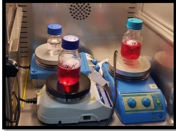
Şekil 5: Aşı formülasyonunun kullanılacak olan virusların (BVDV TR-21, TR-26 ve TR-15) BEI ile inaktivasyon işlemi
