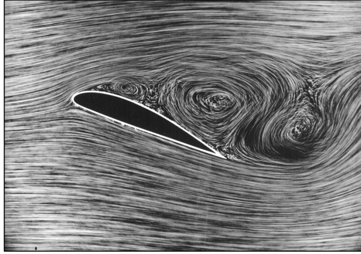
Şekil 3.27. Yüksek hücum açısında kanat üzerinden akışta ayrılma (“Flow Separation,” 2017)
