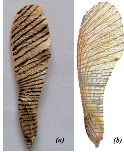
Şekil 3.44. Numune üzerinde kesilmek üzere oluşturulan rastgele çizgiler (a) ve tasarım programında bu çizgilere denk şekilde oluşturulan çizim düzlemleri (b)
