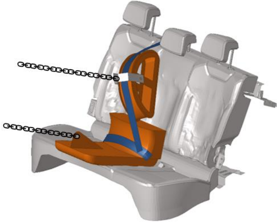
Şekil 3.9. ECE R14 testi sırasında çekme aparatlarının konumu
