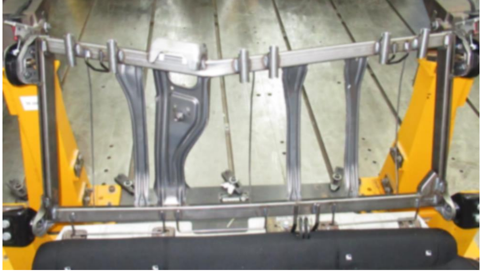
Şekil 4.4. Fiziki testte deforme olan koltuk yapısı
