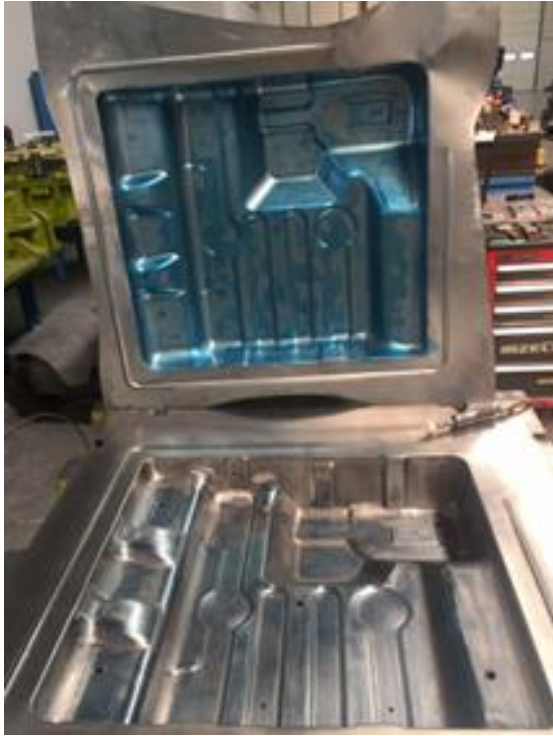
Şekil 4.6. Pres altı ilk deneme sonrası mavi boya deseni
