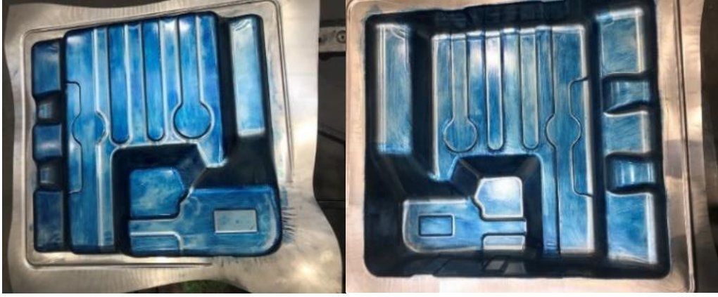
Şekil 3.14. Kalıp kapanana kadar alt ve üst yüzeylerin mavi boya ile kopya desenleri
