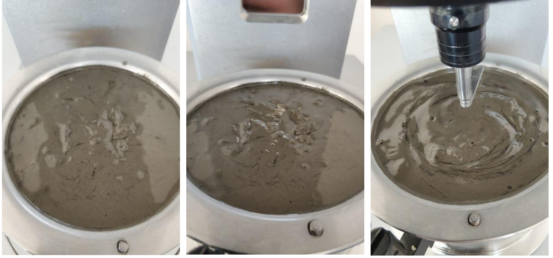
Şekil 4.13. 0.35 s/b oranında PCE içermeyen UK45 hamur karışımının yüzeyinde biriken su
