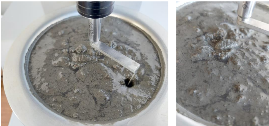
Şekil 4.15. %45 oranında uçucu kül içeren harç karışımlarının yüzeyinde biriken su
