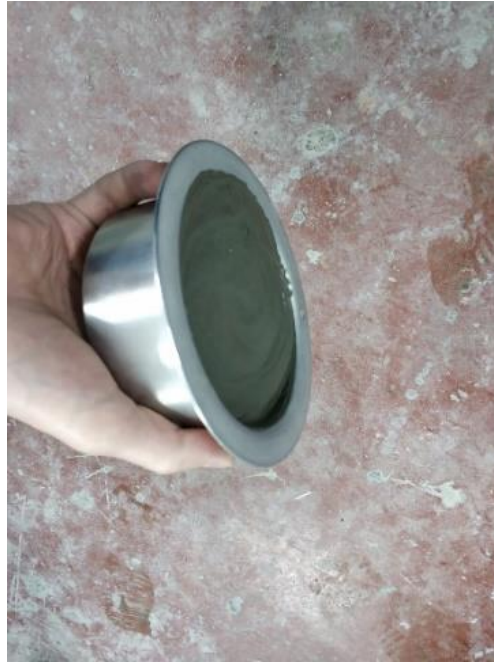
Şekil 3.6. 0,30 su/bağlayıcı oranında ve %0,10 PCE ile hazırlanan C9 çimentosuna ait aşırı katı hamur karışımının reometre kabındaki durumu
