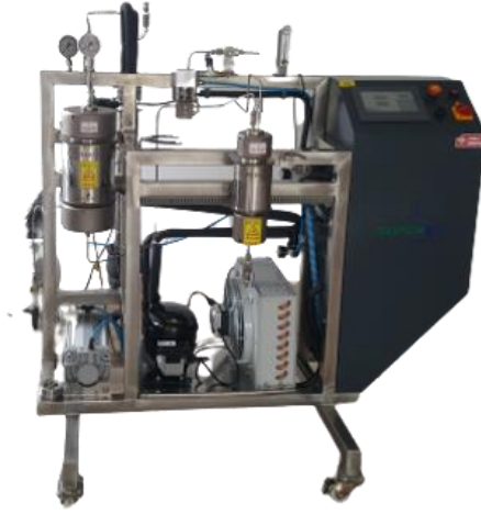
Şekil 3.5. Superex Aero-1000 Sperkritik kurutma sistemi makinası
