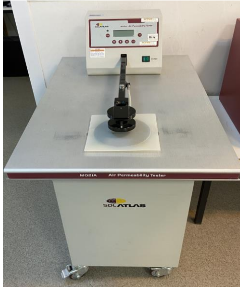
Şekil 3.10. Hava geçirgenliği ölçüm makinasının görüntüsü
