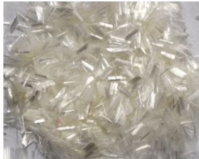
Şekil 2.5: Claremont Flock firmasında üretilen polyester flock lif görüntüsü (Claremont Flock, 2021).
