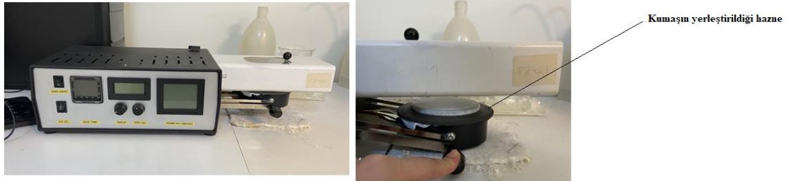
Şekil 3.8. Permatest su buharı geçirgenliği ölçüm cihazı görüntüsü
