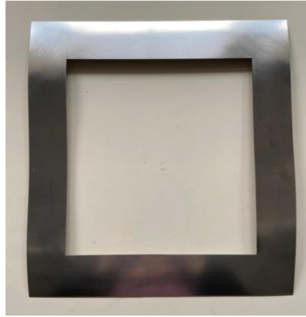
Şekil 3.2. Tam kaplama flok kaplamada kullanılan şablon modeli
