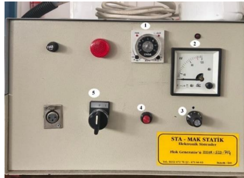
Şekil 3.4. Flock makinasının kontrol paneli 1) Floklama süresinin ayarlandığı düğme, 2) Voltaj göstergesi, 3) Voltaj ayarlama düğmesi 4) Makine ayarları yapıldıktan sonra makinanın çalışmasını sağlayan düğme, 5) Makinanın aç-kapa düğmesi.
