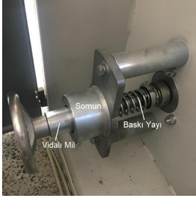
Şekil 3.10. Yay ile baskı kuvveti uygulamasına ait mekanik tasarımı
