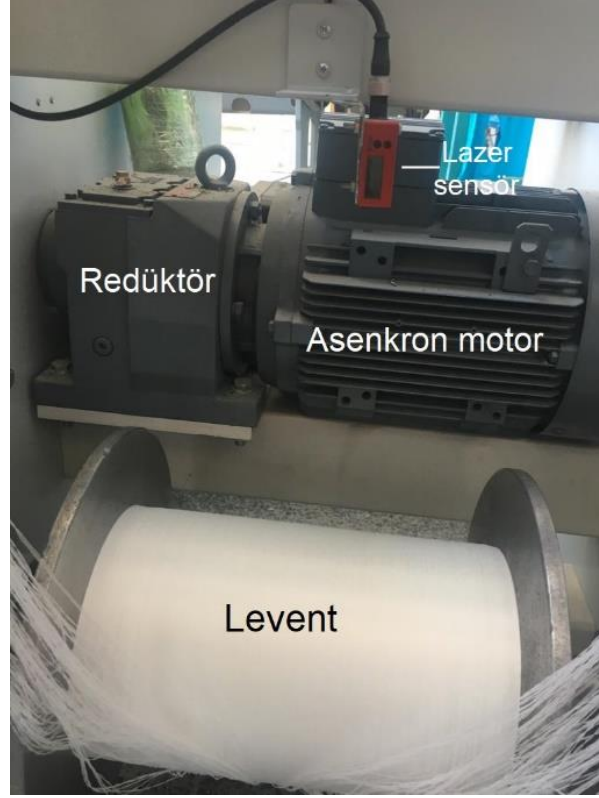
Şekil 3.11. Levendin sarım ünitesini takılmış hali ve lazer sensörün durumu
