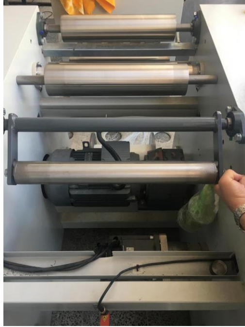
Şekil 3.26. Gerginlik sınırlayıcının prototip ünite üzerindeki görünümü
