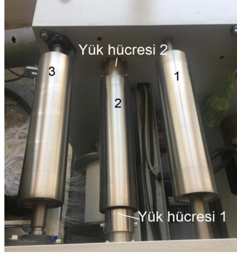
Şekil 3.12. İpliğin geçtiği silindirler ve yük hücrelerinin konumu
