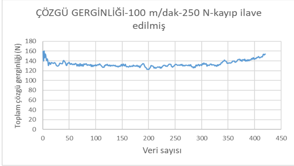
Şekil 4.18. Kayıp tork ilave edildiğinde çözgü gerginliğinin levent çapına göre değişimi.
