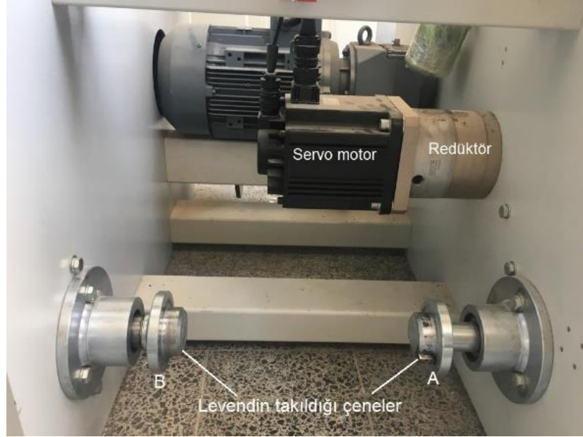
Şekil 3.9. Servo motor tahrikli leventlerin takıldığı ünite
