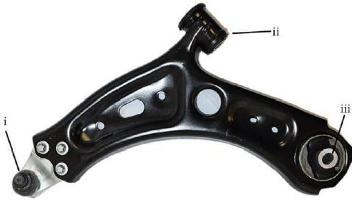
Şekil 2.11. Salıncak kolundaki elastik burçlar (Messana vd. 2020)
