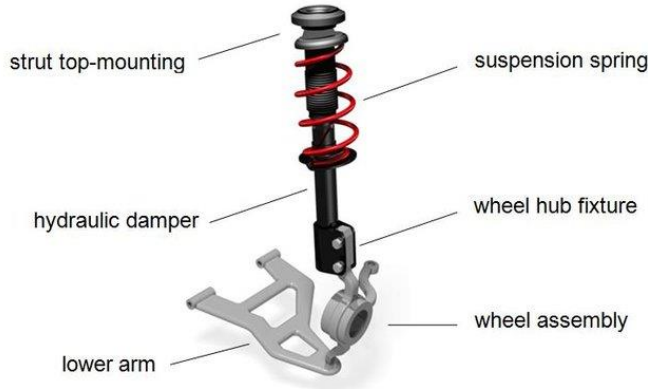
Şekil 2.5. McPherson amortisör yapısı (Czop 2011)
