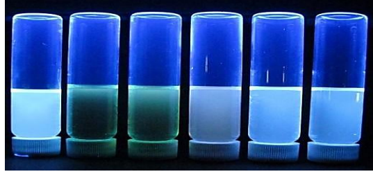
Şekil 4.14. Soldan sağa, P4 çözeltisi, 10 eq TNP, DNP, DNT, TNB ve NT varlığında UV ışığı ( \lambda_{exc} :360 nm) altında görüntüleri
