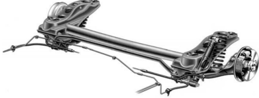
Şekil 2.13. Bağımsız Süspansiyon- Çeki kolları (Mercedes-Benz A sınıfı)
