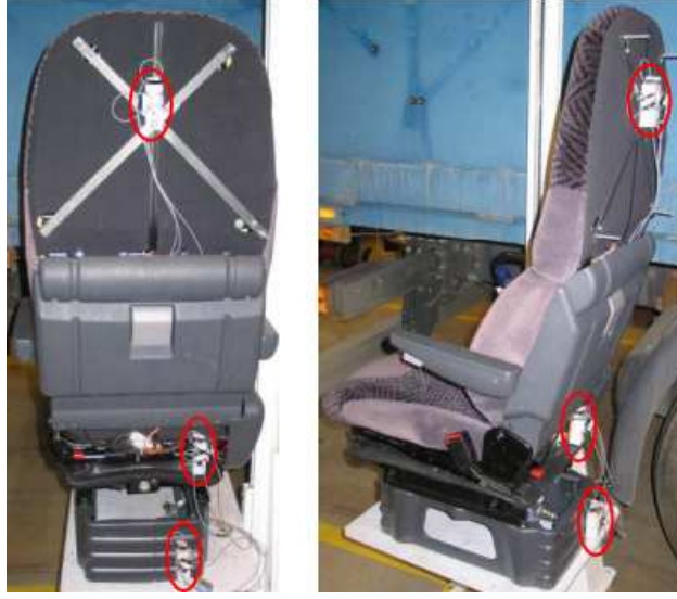
Şekil 3.4. Bir araç konfor testi için ivme ölçer lokasyonları
