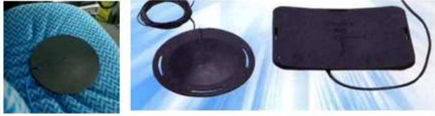
Şekil 3.6. Koltuk için özel tasarım ivmeölçerler
