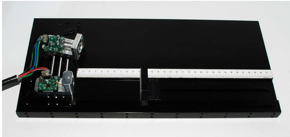
Şekil 4.22 PSD aygıtı düz konumdayken üçgenleme kurulumu
