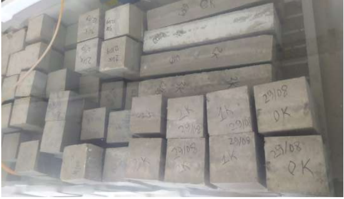
Şekil 3.16. Kür havuzunda standart koşullar altında beklenen numuneler
