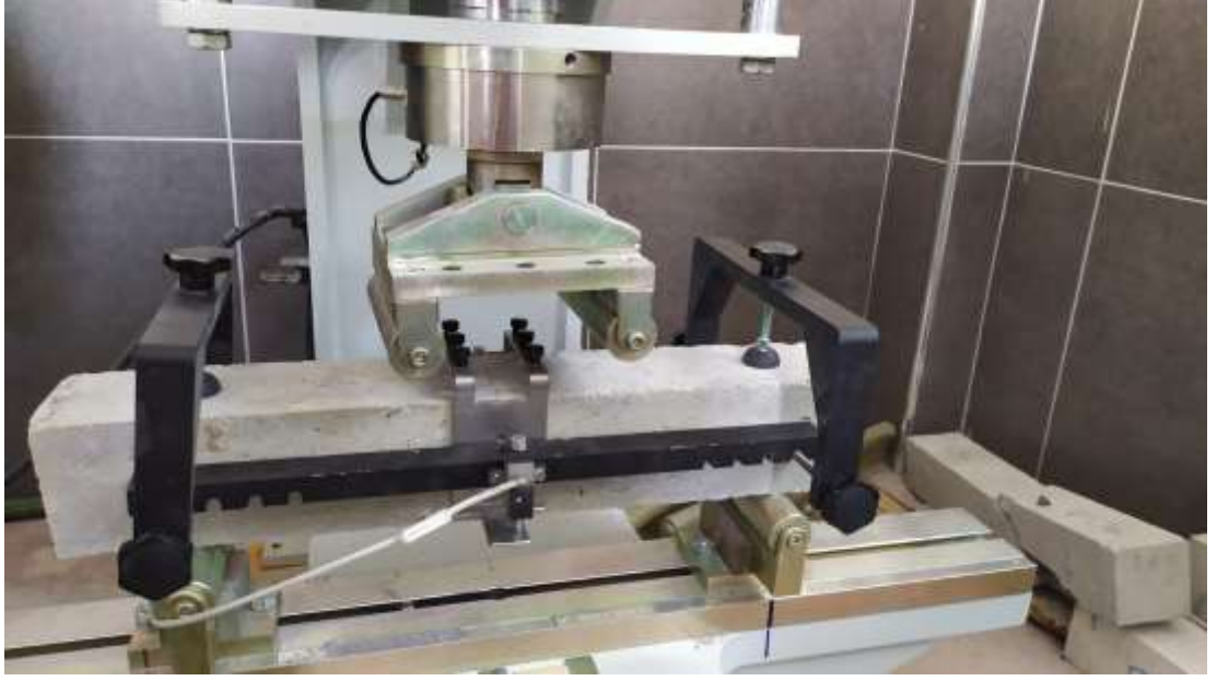
Şekil 3.24. Eğilmede çekme dayanımı deney cihazı
