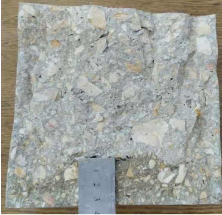
Şekil 3.27. Basınçlı su altında su işleme derinliği testinden sonra yapılan ölçüm
