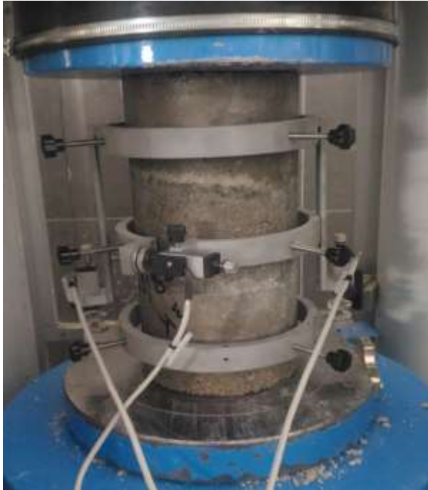
Şekil 3.25. Elastisite modülü deneyi
