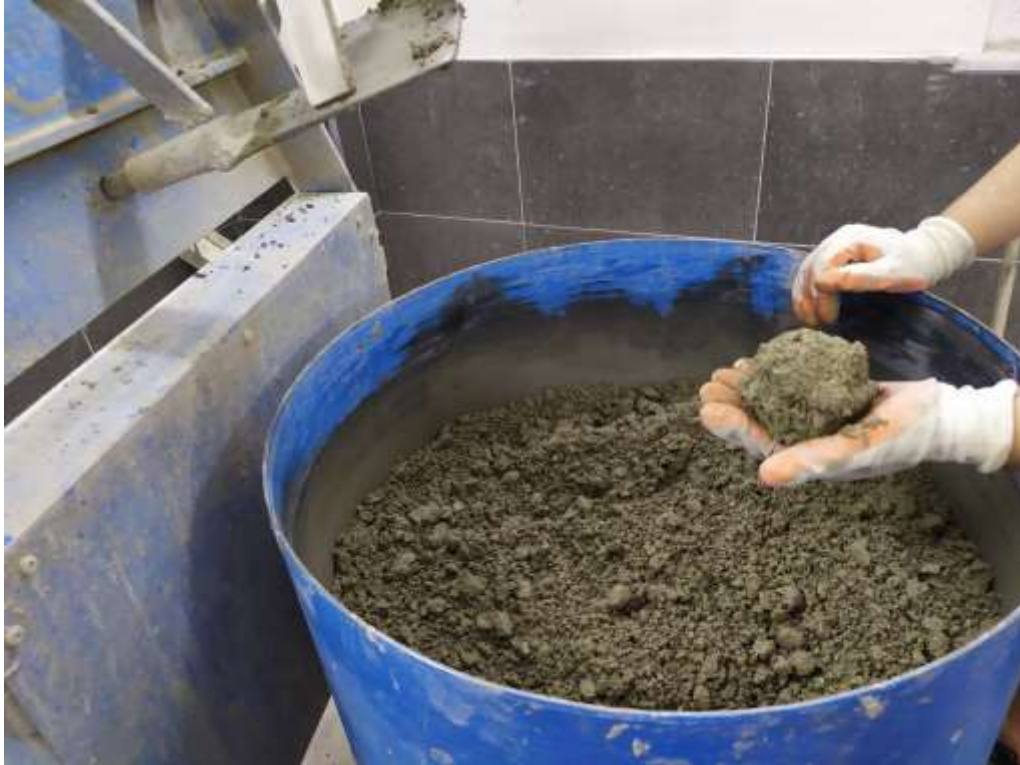
Şekil 3.3. SSB karışımı hazırlamasında kullanılan Pan tipi mikser
