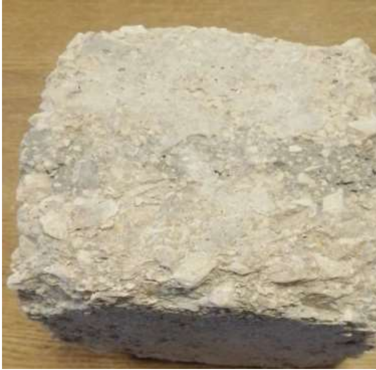
Şekil 4.37. 300 donma-çözölmeye maruz kalan katmanlar arası harç uygulanan K karışımının görünümü
