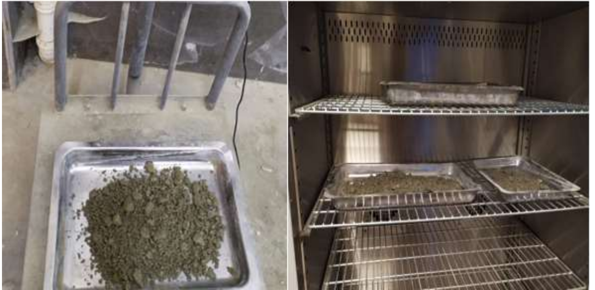
Şekil 3.6. SSB’nin su muhtevasını belirlemek için alınan numune ve 105 °C sıcaklığındaki etüvde kurutulması
