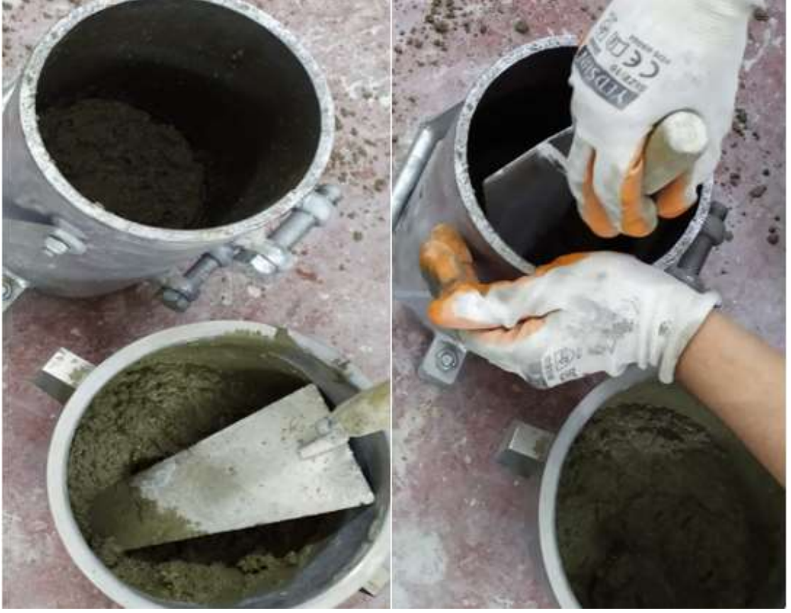
Şekil 3.19. SSB numunelerinde katmalar arası harç uygulaması
