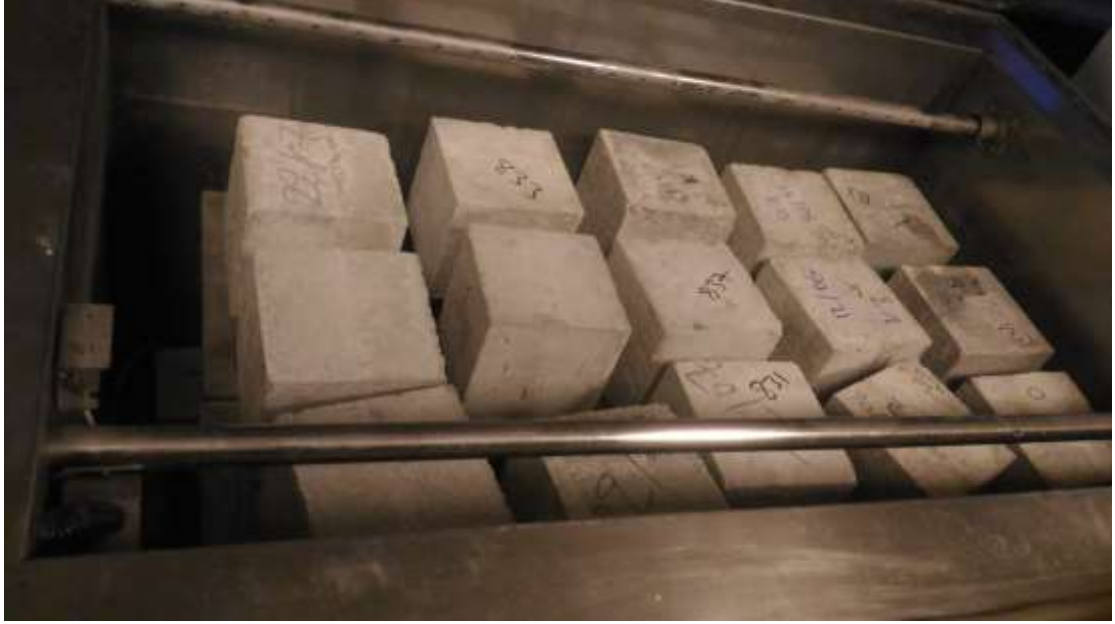
Şekil 3.28. Donma-çözülme için kullanılan deney cihazı ve numunelerin yerleştirilmesi
