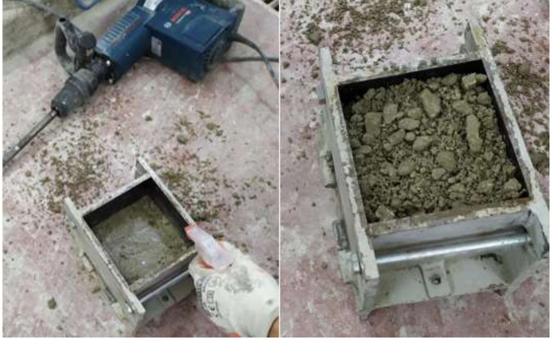
Şekil 3.17. Katmanlar arası aderans artırıcı kimyasal katkının uygulanması
