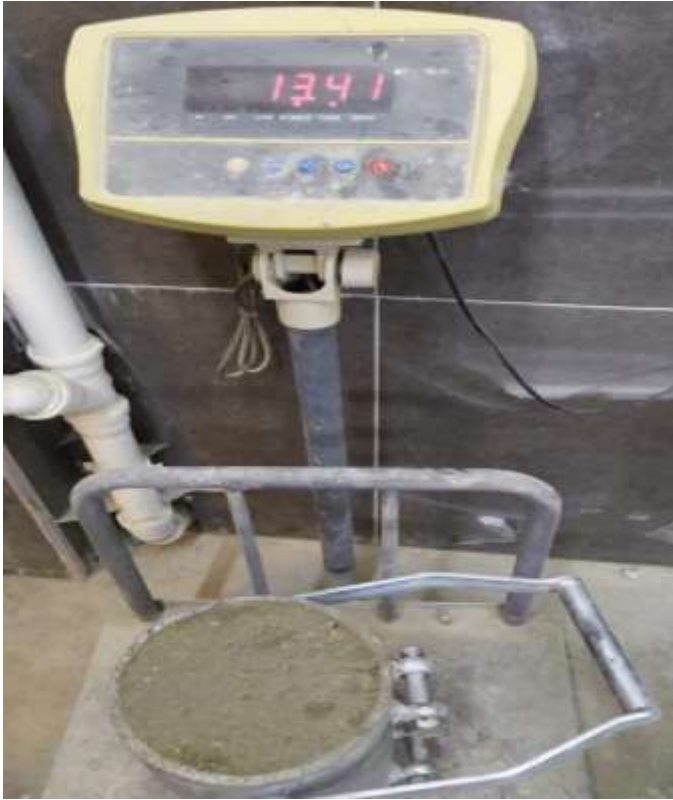
Şekil 3.7. Kalıba sıkıştırılarak yerleştirilen taze betonun ağırlığı
