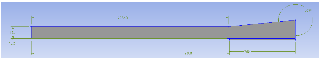
Şekil 3.9. 6 derece açılı Driver ve Segmiller (1985) geometrisi analojisi (DS5)
