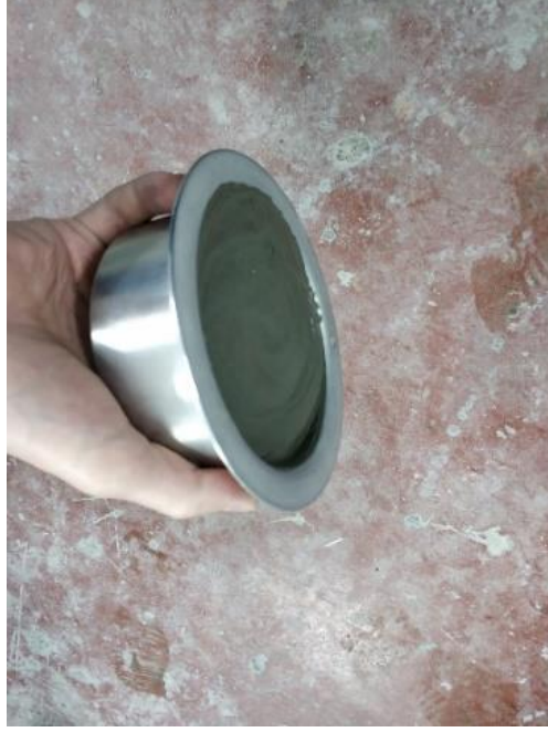
Şekil 3.10. 0,30 su/bağlayıcı oranında, %0,10 PCE dozajı ve C9 çimentosu ile hazırlanan aşırı katı kıvamdaki hamur karışımının reometre kabındaki durumu
