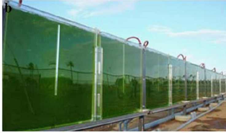
Şekil 2.8. Düz panel fotobiyoreaktör sistemler (Bitog vd., 2011)
