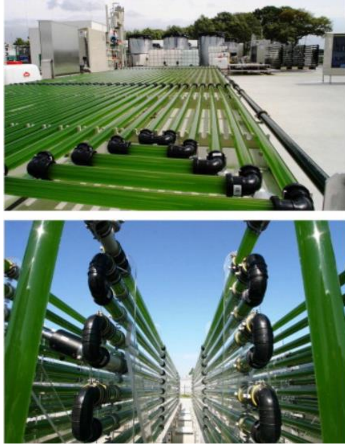
Şekil 2.5 Yatay ve düşey tübüler fotobiyoreaktör sistem örnekleri (Slegers vd., 2013)
