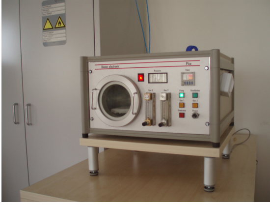
Şekil 2.2. PICO LF (Diener Electronic) plazma aplikasyon cihazı
