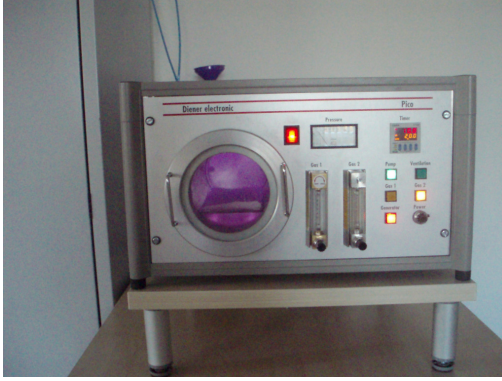
Şekil 2.3. Plazma aplikasyonu yöntemi: Akrilik asit monomeri ile hidrofilleştirme işlemi
