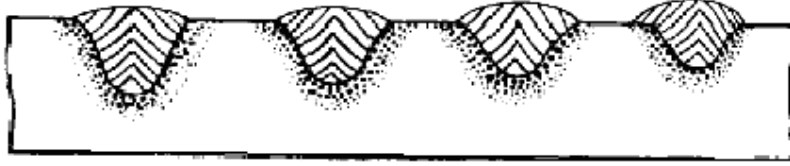
Şekil 1.6. Tel çapının dikiş formu üzerindeki etkisi
