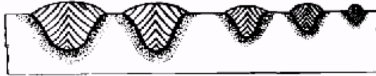
Şekil 1.8. Kaynak hızının dikiş formu üzerindeki etkisi
