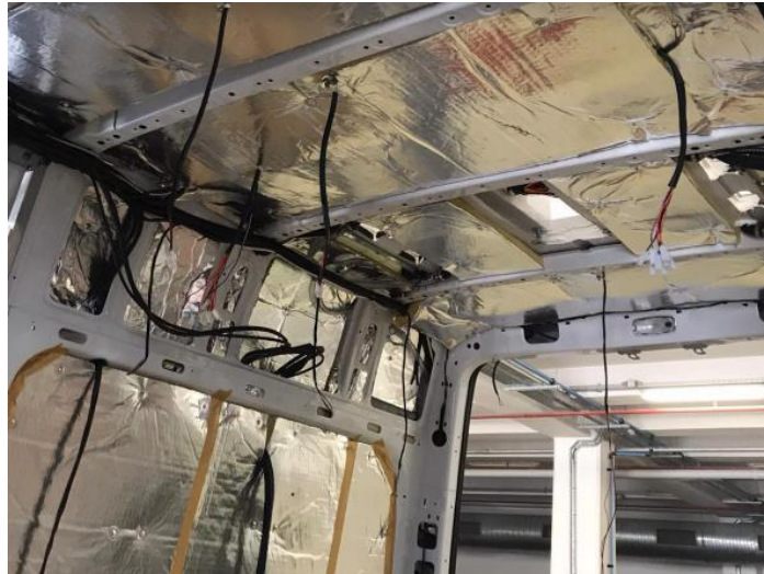
Şekil 3.14. Ambulans kabinine uygulanan yalıtım işlemi
