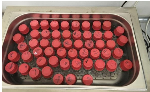
Şekil 3.2.4 AOK şişelerine doldurulan örneklerin pastörizasyonu
