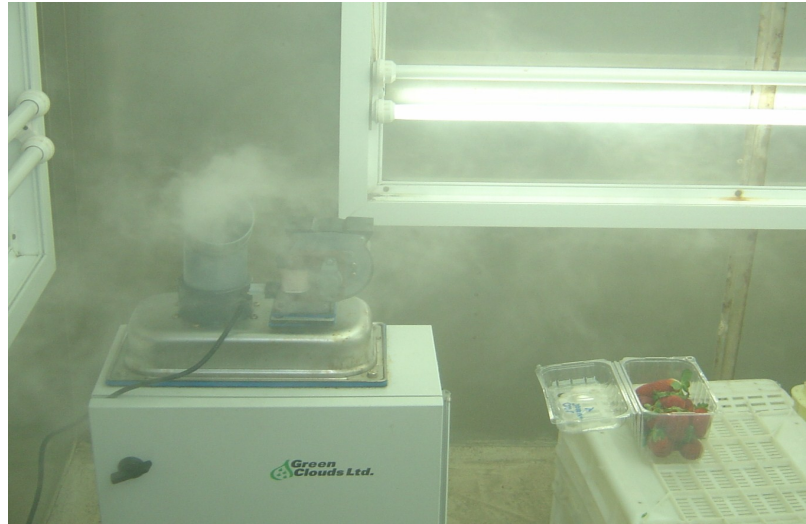
Şekil 3.2. Denemede kullanılan kimyasal maddelerin ultrasonik aerosol jeneratörle sisleme şeklinde meyvelere uygulanışı.
