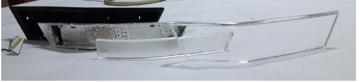
Şekil 4.18. Işık tüpü, bezel ve PCB prototipleri ile birlikte mevcut gövde ve lens alt bileşenlerinin montaj sırasına göre birbirlerinden ayrılmış durumu
