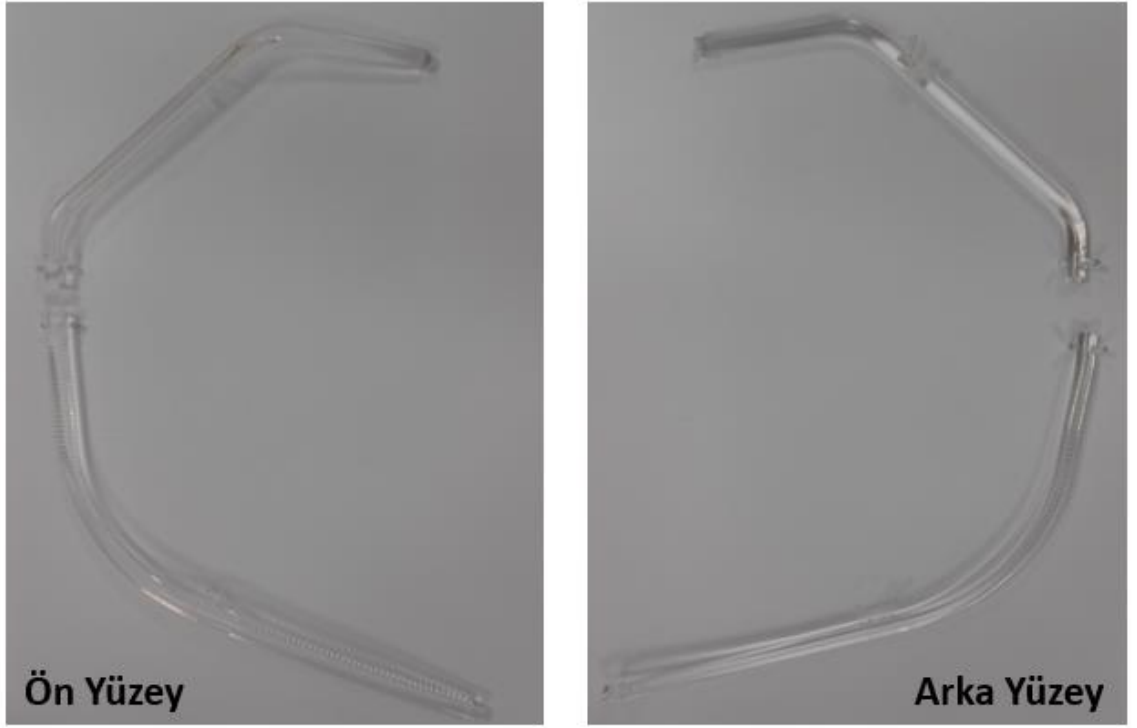
Şekil 4.39. Alt ve üst ışık tüpü prototiplerinin ön ve arka yüzeylerinden alınan görüntüler
