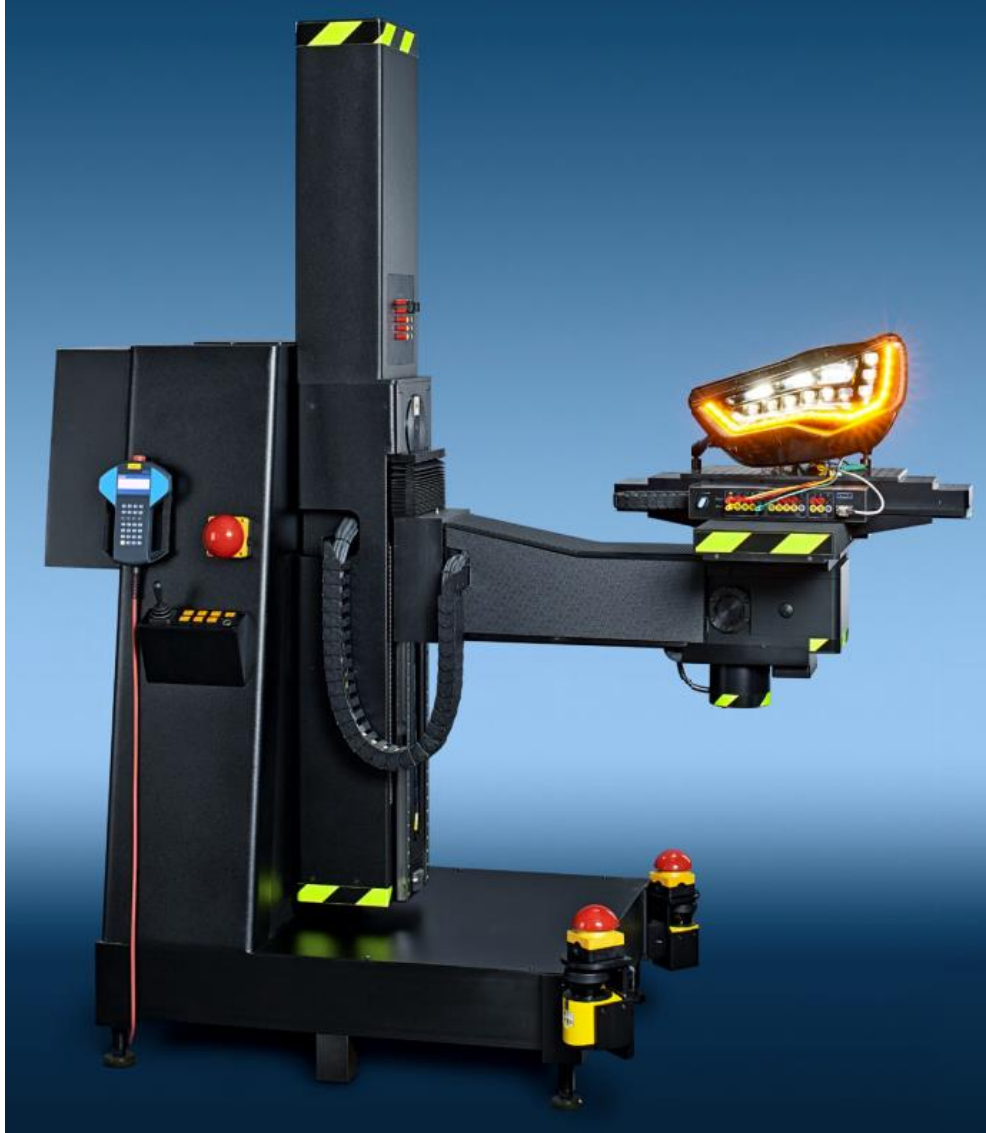
Şekil 3.11. Fotometri ölçümlerinde kullanılan IES LM-75-01' e göre Tip-A olan LMT GO-H 1660 model ganyometre
