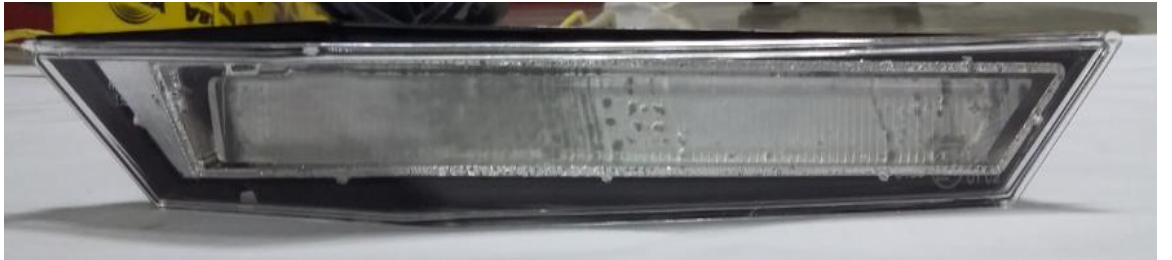
Şekil 4.19. Işık tüpü, bezel ve PCB prototiplerinin mevcut lamba üzerinde gövde ve lens ile birlikte montajlı durumu
