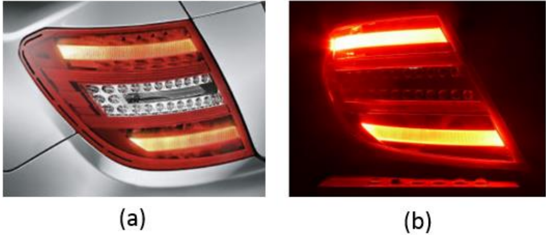
Şekil 3.4. Mercedes Benz C-Serisi 3. Nesil ASK lambası, a) ASK’ nin araç üzerindeki konumu (Car.info, t.y.), b) ASK’ nin arka pozisyon fonksiyonunun açık olduğu durum
