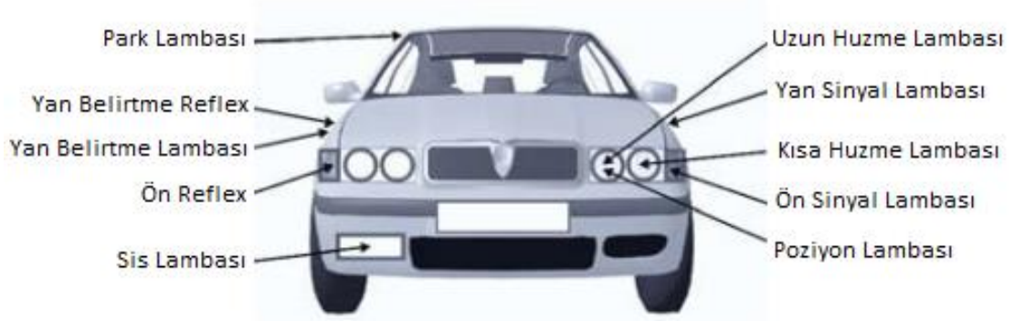
Şekil 2.2. ECE Standartlarında belirlenen otomotiv ön aydınlatma fonksiyonları
