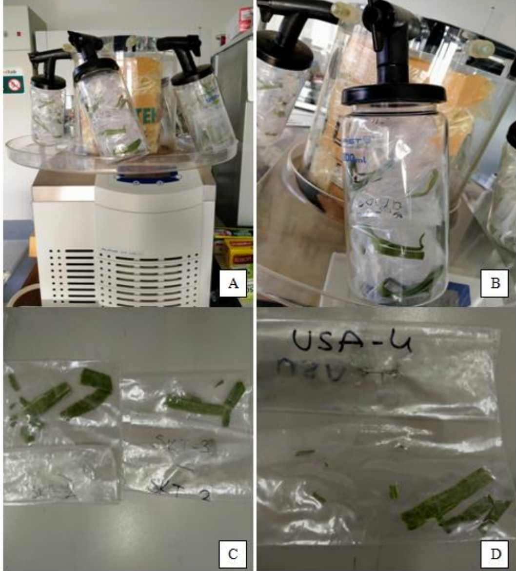
Şekil 3.3. Yaprak örneklerinin kurutulması A) Liyafilizatör cihazı (Christ Alpha 1-4 LD Plus) B) Örneklerin cihaza yerleştirilmesi C-D) Kurutulan yaprak örneklerinin görünümü.
