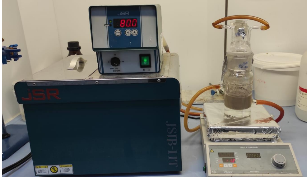
Şekil 3.1. Süspansiyon polimerizasyonu yöntemi ile polimer partiküllerin sentezi
