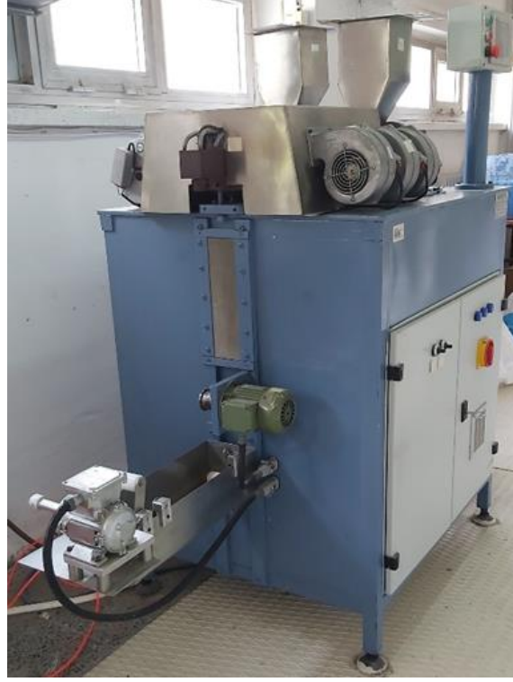
Şekil 3.1. Filament üretiminde kullanılan sentetik iplik üretim makinesi
