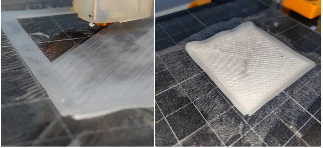
Şekil 3.22 SABIC® PP tek katmanlı baskı örneği.
