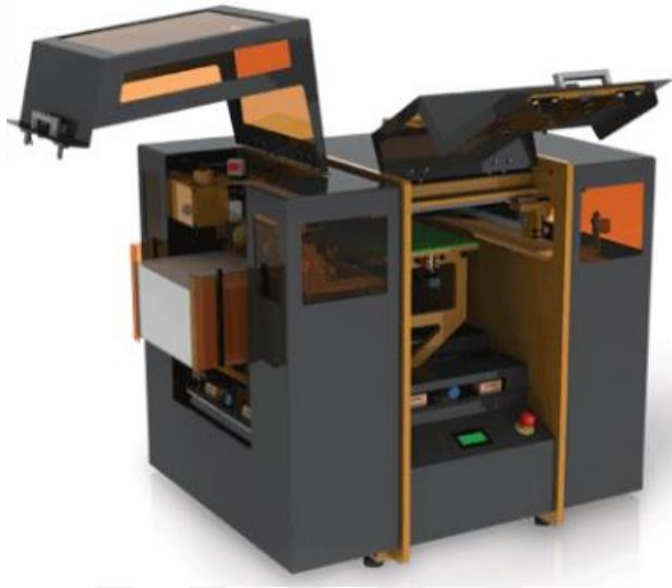
Şekil 2.8 Lamine Nesne Üretimi LOM yazıcı örneği (Uludağ, 2020).
