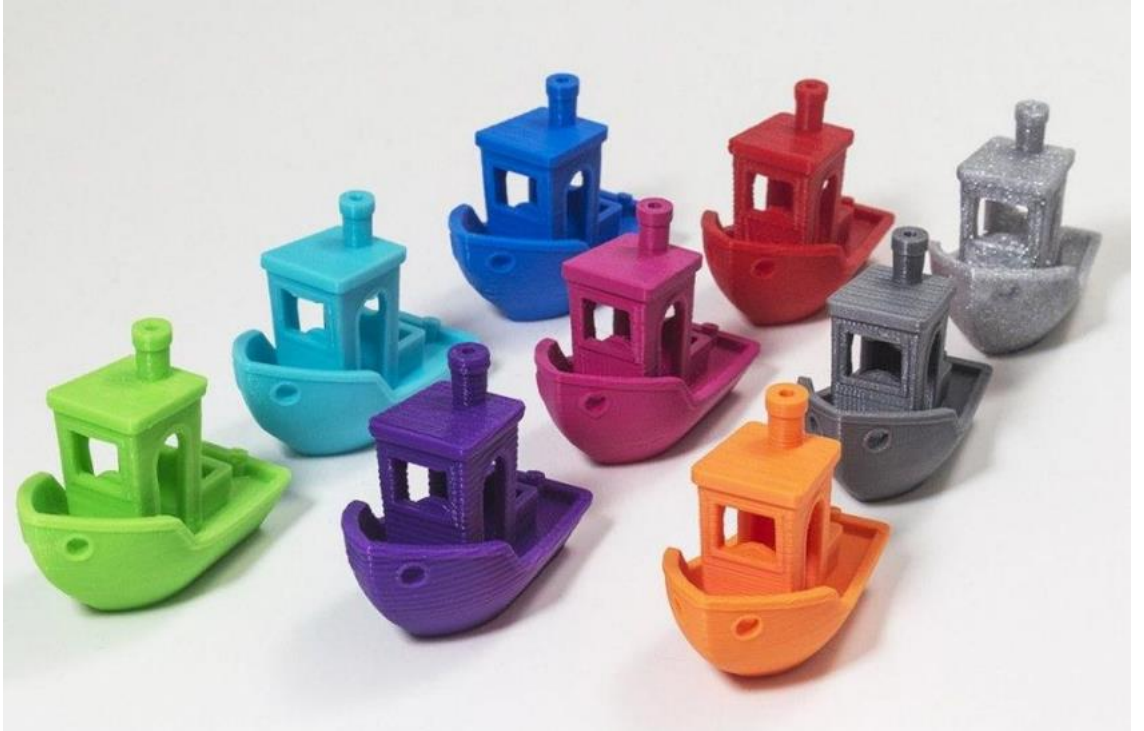
Şekil 2.9 PLA malzemesiyle yazdırılmış parça örnekleri (Uludağ, 2020).
