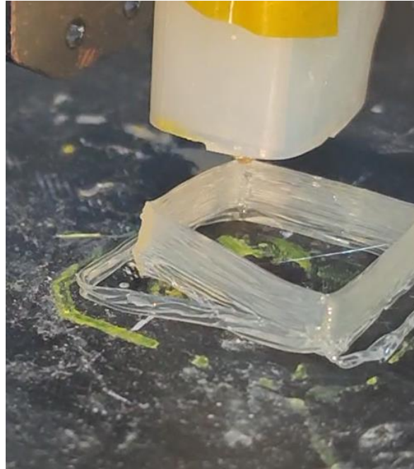
Şekil 3.11 Yanlış koordinat tanımlanmış parça örneği.
