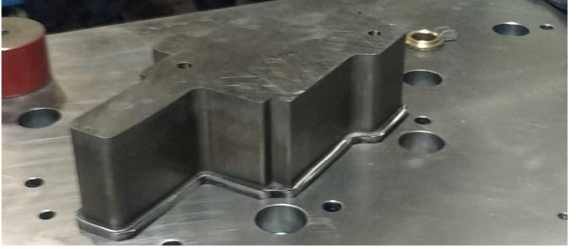
Şekil 4.34. Açılı yüzey işleme sonrası kesme çeliği son hali (yandan)
