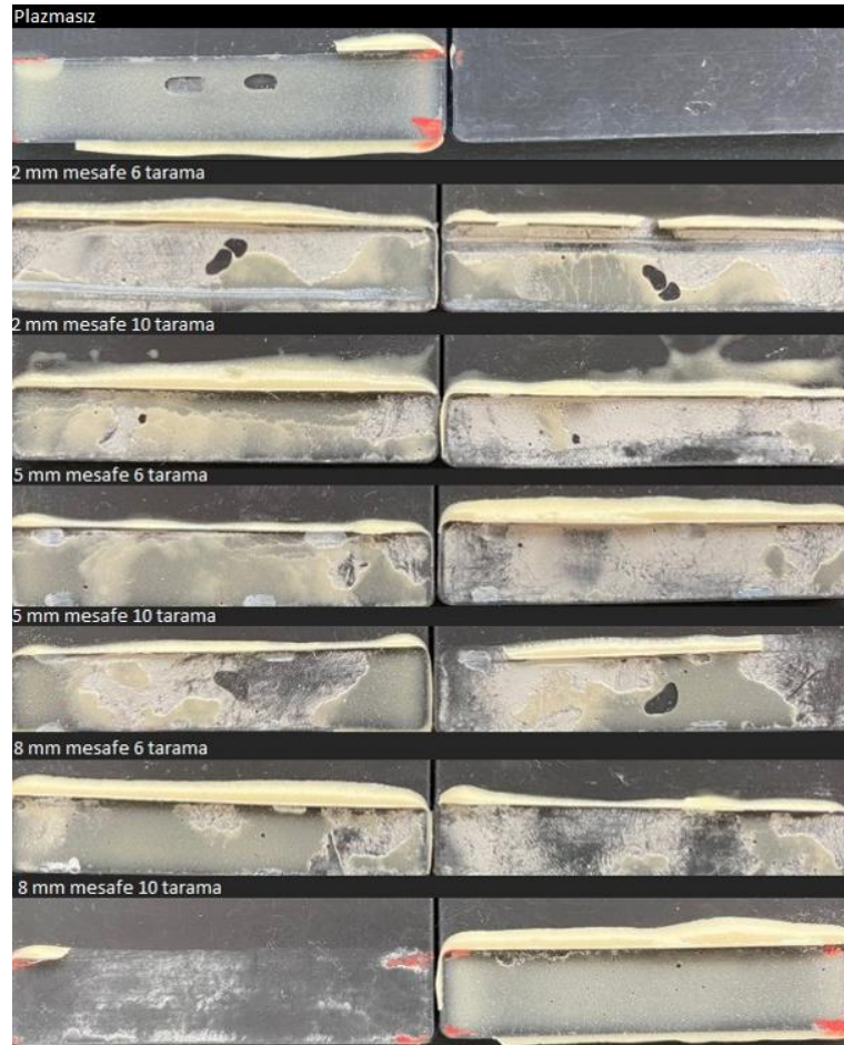
Şekil 4. 7.Farklı işlem mesafeleri ve tarama sayılarında ABSP uygulanan PP numunelerinin çekme testleri sonrası ayrılma yüzey fotoğrafları
