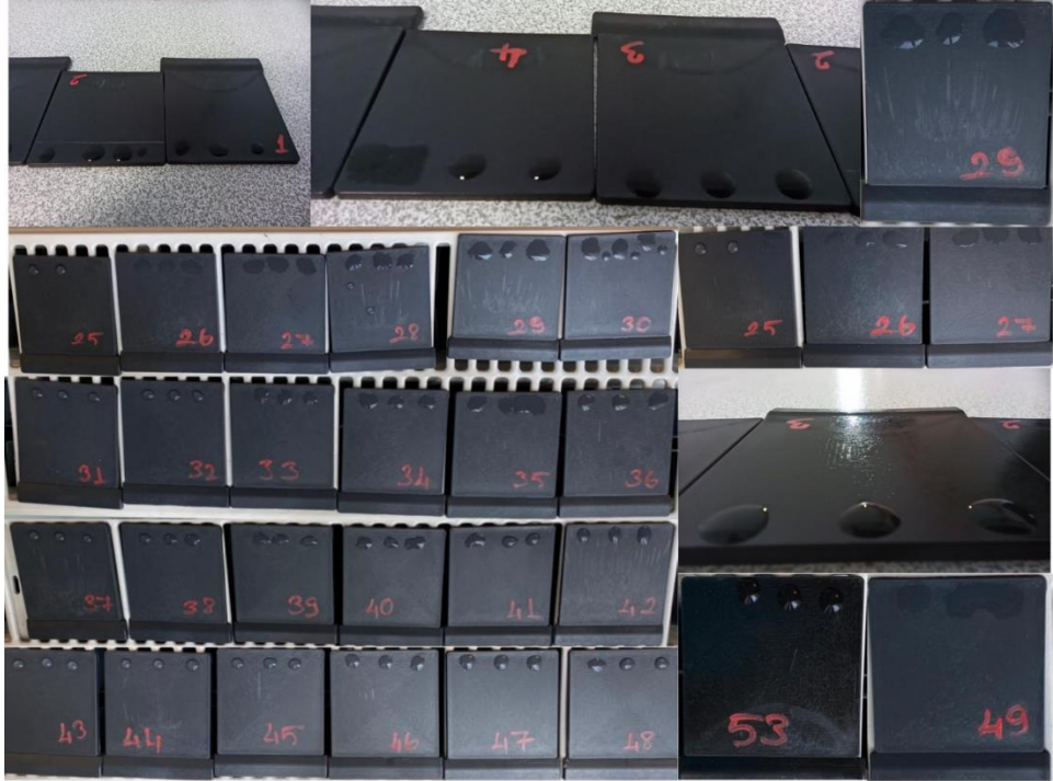
Şekil 3. 4. ABSP uygulamasının ardından numune yüzeylerinde su damlacıklarının oluşturulması
